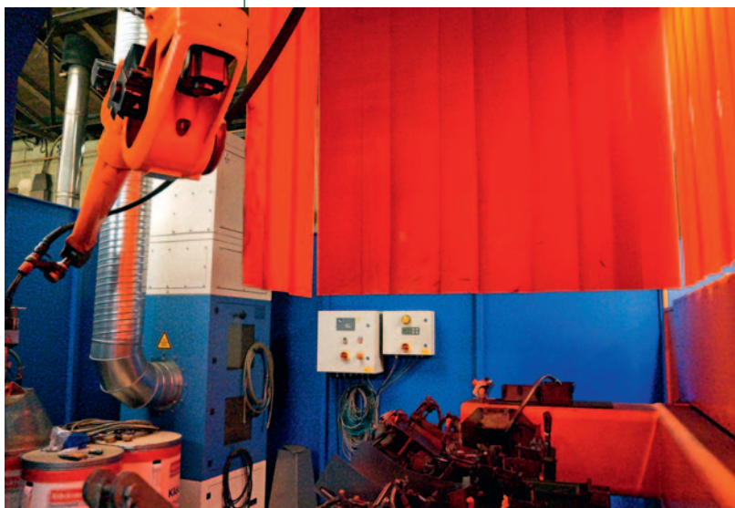
Робот, осуществляющий плавку при изготовлении корпусов садово-парковой техники
